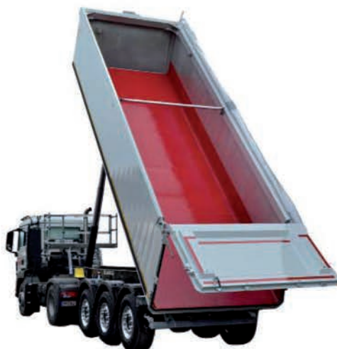
Ein typischer Anwendungsfall sind die Muldenauskleidungen. (Foto: Pucest)
