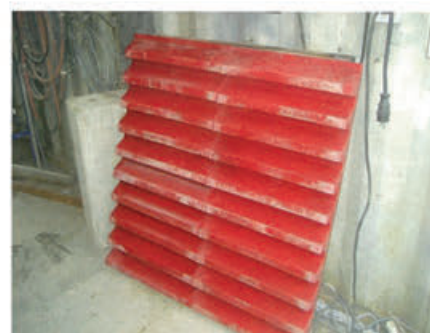
ANDERSHERUM DENKEN – und einbauen. Pucest-Stufenprallplatte „upside down“, das heißt, die Öffnungen zeigen nach unten.
