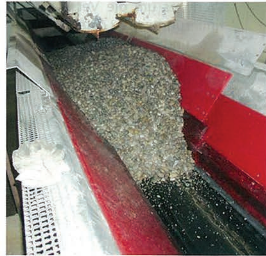
Lange Standzeiten: Förderrinne mit Pucest-Verkleidung nach vier Monaten Dauerbelastung.
